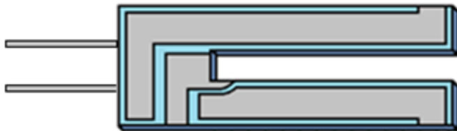
Rys. 6.13 Model 2D obrazujący budowę kamertonu
