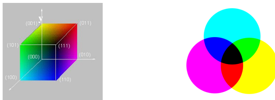
Rys. 3. Sześcian kolorów CMY i zasada subtraktywnego mieszania barw
