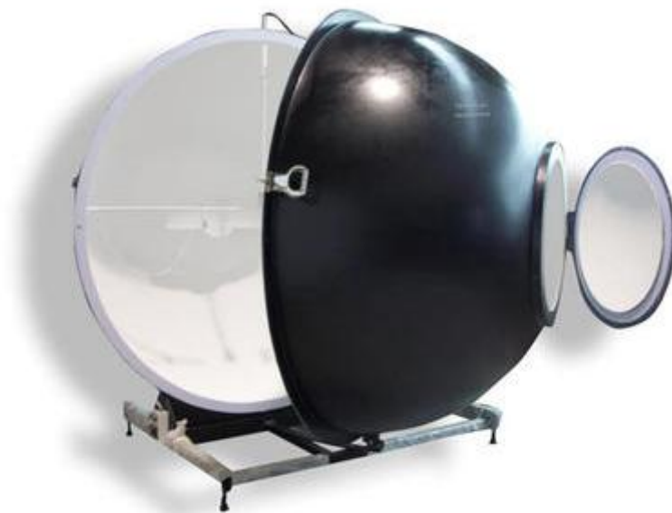
Rys. 6. Kula Ulbrichta do pomiarów strumienia świetlnego[7]
